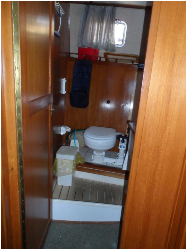
Toilette: mit Pump-WC und Duschwanne
