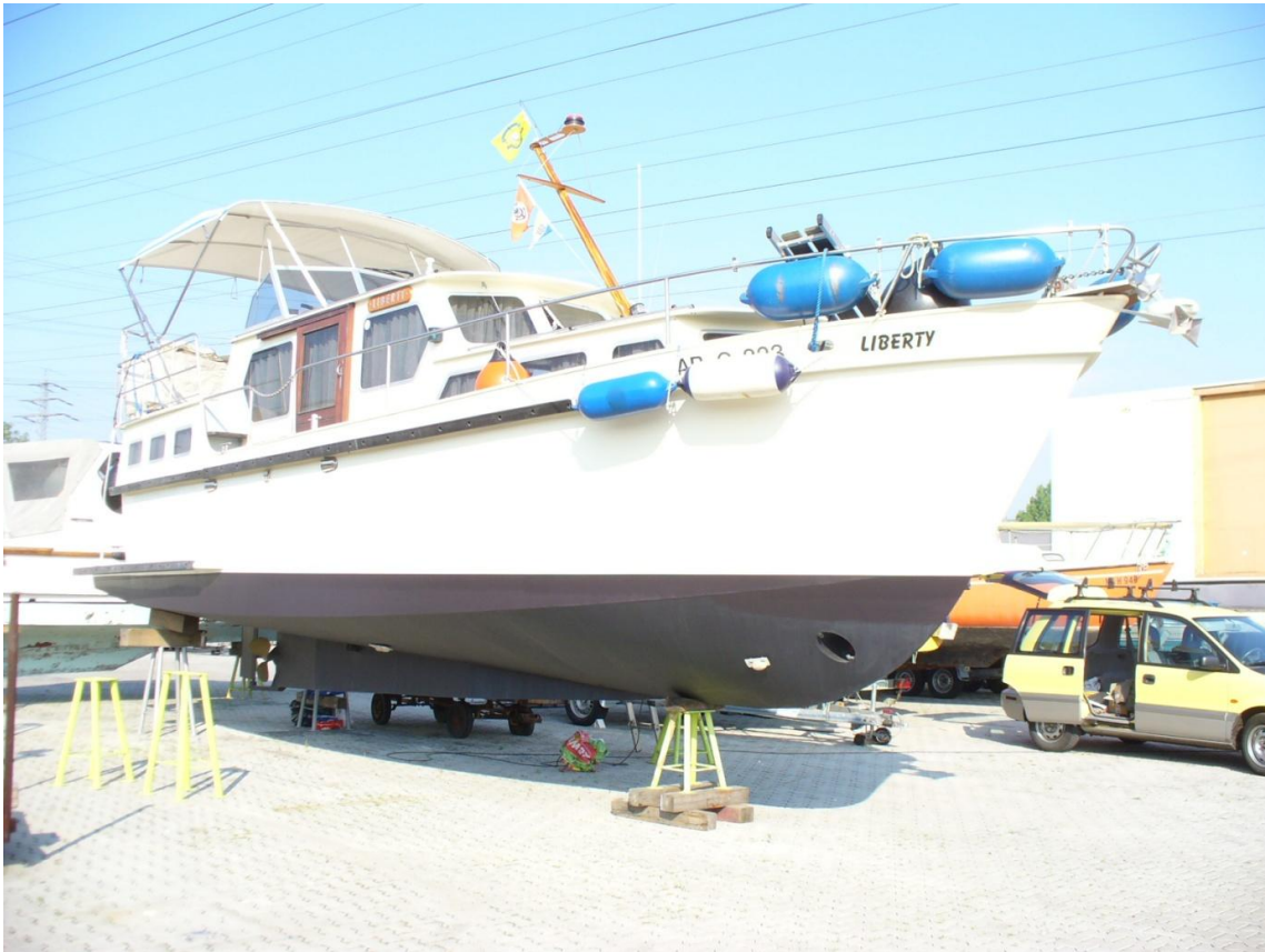
Liberty 2007 (nach Sandstrahlen und Neuaufbau des Unterwasserbereichs)
