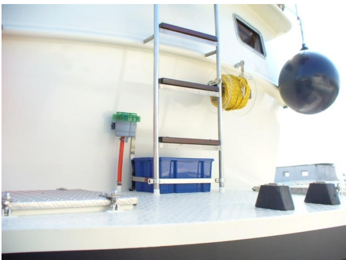
Die neue Badeplattform mit 2 Lukendeckeln, Fäk.-Tank-Entlüftung, Leinenrolle, Kasten für Heckanker und Kette, Konsolen für Einhängen der Badeleiter.
