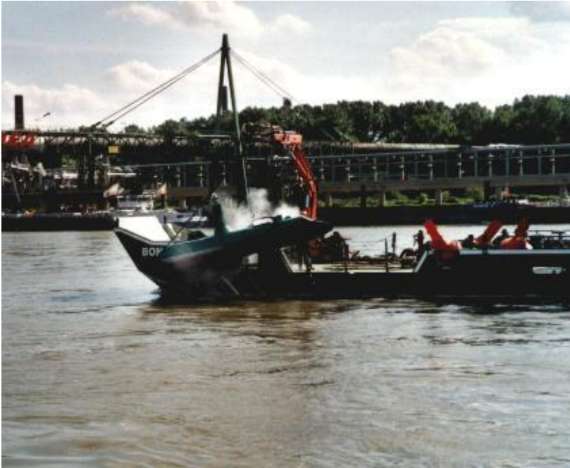
eine Fahrwassertonne wird gereinigt
